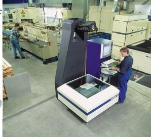
Le logiciel d'utilisation facile permet à tout un chacun de commander le LaserQC dans l'environnement de la production. Le LaserQC projette automatiquement le contour extérieur sur le banc d'essai. Dès que le produit y est posé, le mesurage commence et toutes les données concernant la couleur, la dimension et la déviation sont affichées clairement sur l'écran 17".
