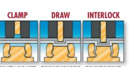
THE METAL IS CLAMPED THE PUNCH DRAWS THE THE JOINT IS FORMED METAL INTO DIE
